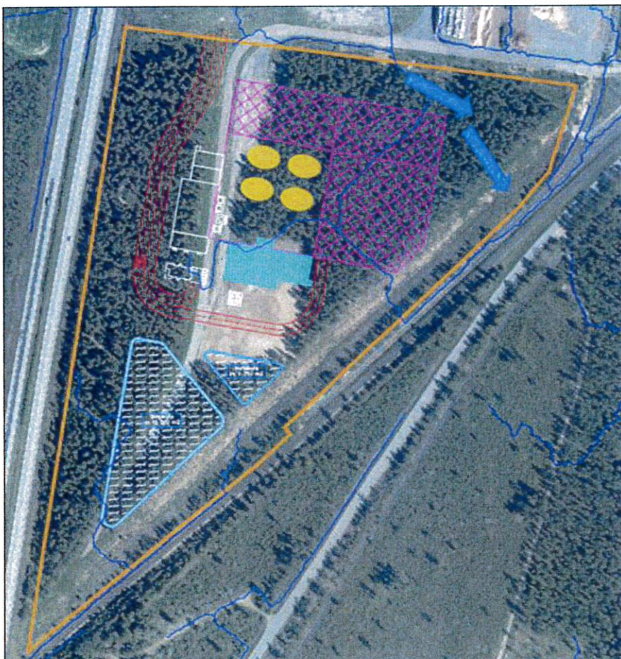
Figur 16. Föreslagen omledning av skyfallsstråket, i förhållande till skiss av planerad exploatering (ScalgoLIVE).
