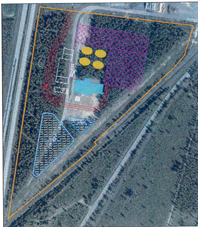
Figur 5. Skiss av planerad exploatering inom planområdet (Vaggeryds Energi AB). Orange = fastighetsgräns; Röd, turkos, vit, gul, rosa = planerad hårdgjord yta; Blå = preliminära ytor för dagvattenhantering.
